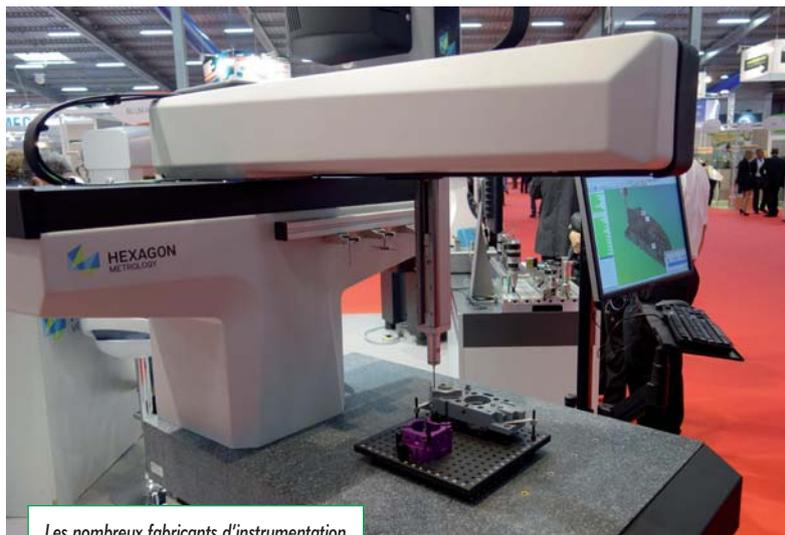
Les nombreux fabricants d'instrumentation proposent tous avec leurs nouvelles machines, plus de précision plus rapidement et plus simplement. Ici, une MMT Hexagon avec palpeur Leitz en action.
