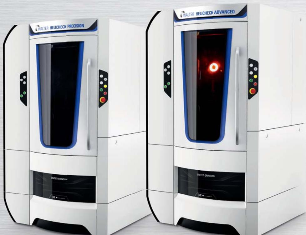
Cette gamme de machines permet la mesure d'outils de Ø 2 à 320 mm et jusqu'à une longueur de 420 mm.
