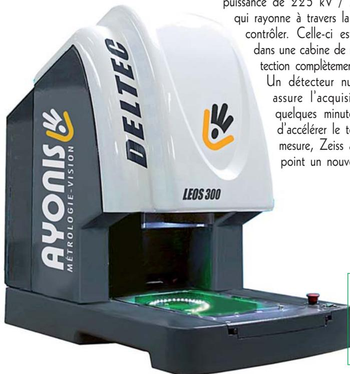
Sur les projecteurs de profil Deltac d'Ayonis, la pièce est reconnue et la gamme de contrôle automatiquement chargée et exécutée. Une seconde après (pour une mesure sans scan) l'opérateur obtient un résultat du type « Bon » ou « Mauvais ». L'opérateur pose la pièce suivante ou déclenche l'édition des rapports de mesure.
